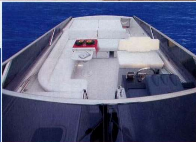
Sopra, il pozzetto è coronato dal parabrezza che ha il profilo in acciaio sagomato per fungere anche da tientibene.
